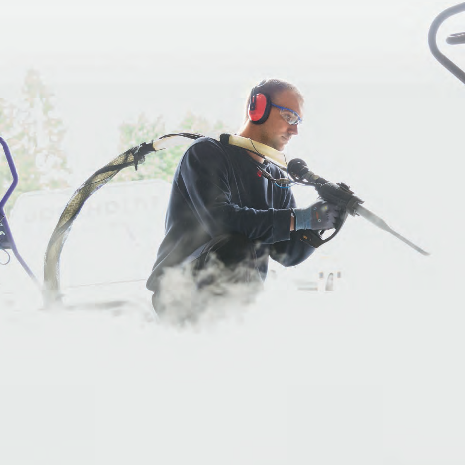
André Schlichting reinigt mit einer Trockeneismaschine.
